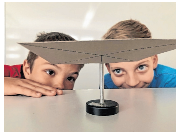
Wenn man den Schwerpunkt unterstützt, „schwebt“ der Karton.
