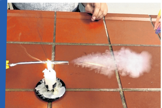
Da der Druck nur in eine Richtung entweichen kann, wird das abgebrochene Streichholz herausgeschossen. Fotos: Fredi Zimmermann
