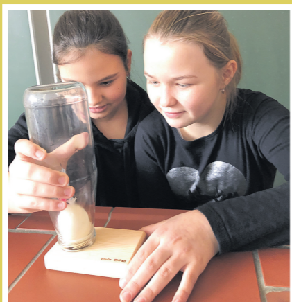
Durch den äußeren Luftdruck wird das Ei in die Flasche gedrückt.
