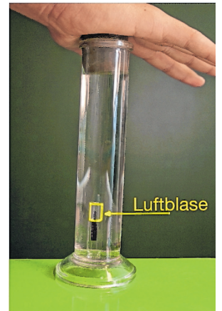
Ohne Druck (links) und mit Druck (rechts). Hier wird die Luft im Röhrrchen zusammengepresst und es sinkt.
