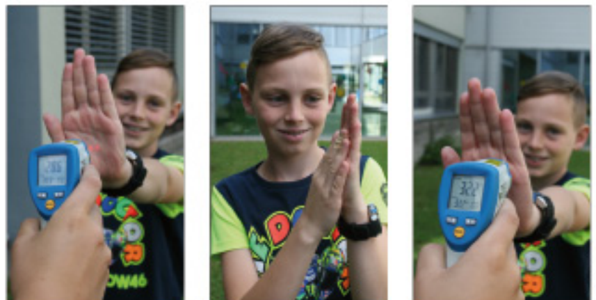
Die Temperatur der kalten Hand von Maximilian liegt bei 28,6^{\circ}\text{C} (links), nach dem Händereiben steigt sie auf 32,2^{\circ}\text{C} (rechts).
