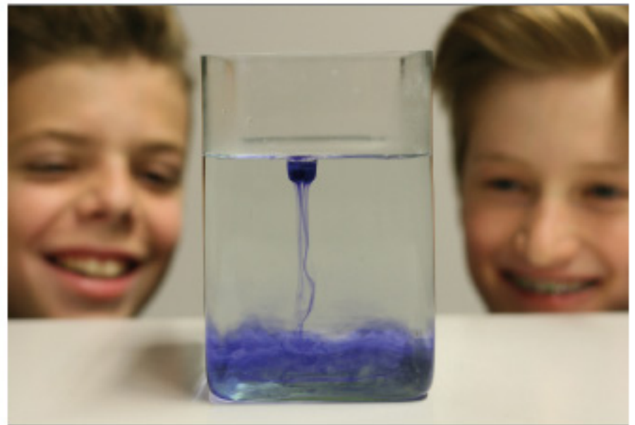
Kaltes Wasser (blau gefärbt, damit du es siehst) sinkt nach unten.
