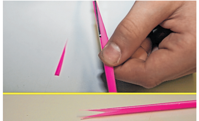
Drück den Plastikstrohhalm flach (Bild oben) und schneide dann eine Spitze ein.
